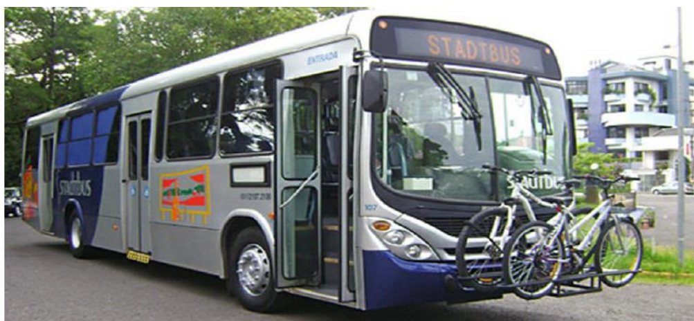
Figura 39 – Ônibus adaptado para transporte de bicicletas.
